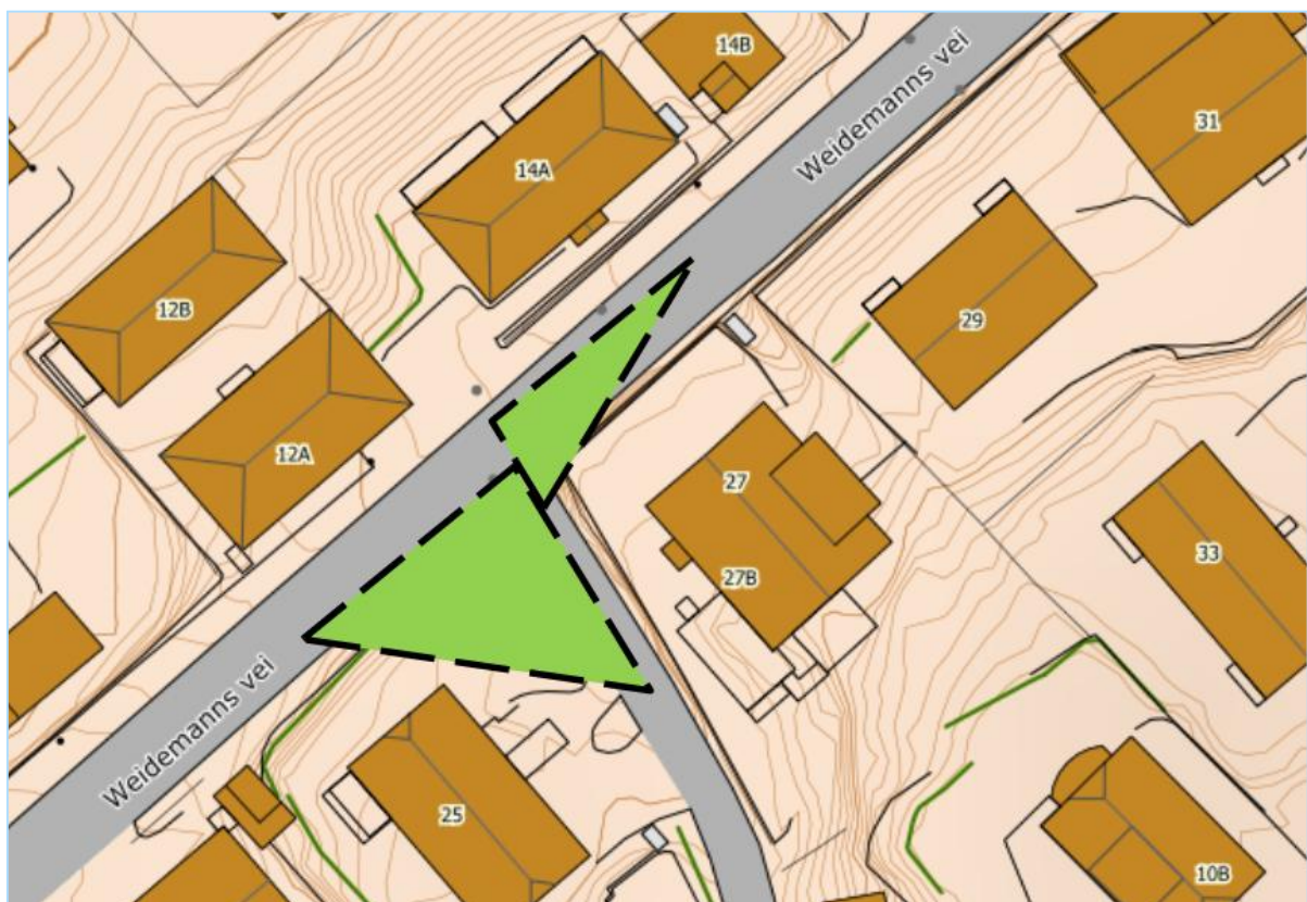
Figur 27 Skisserte sikttrianter i krysset Weidemanns vei X Sigurd Bergs allé med dagens uregulerte T-kryss
