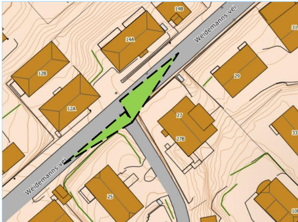
Figur 28 Siktkrav i situasjon ved forkjørsregulert kryss i Weidemanns vei X Sigurd Bergs allé
