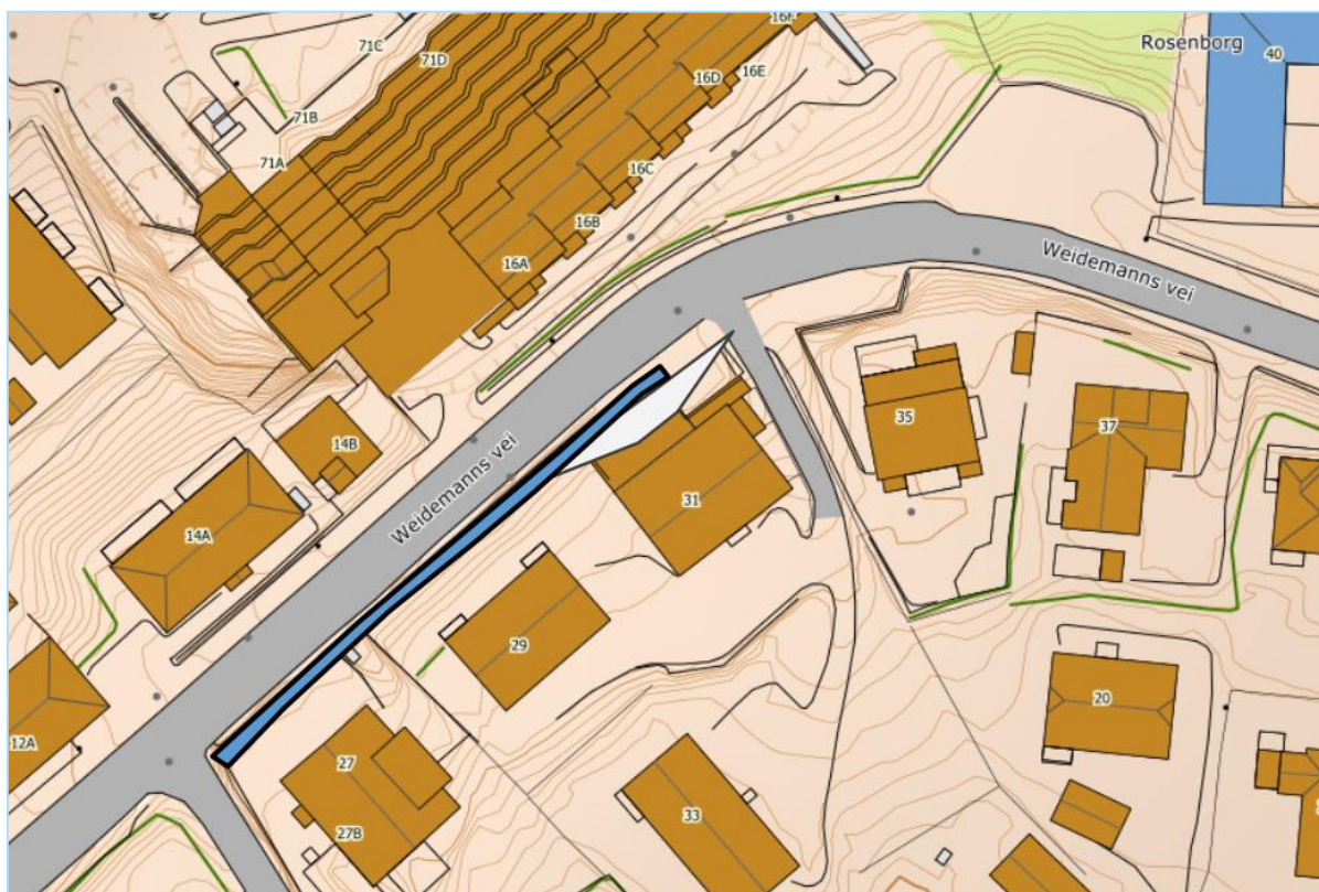
Figur 30 Mulig løsning med tosidig fortau og lomme for renovasjonskjøretøy
