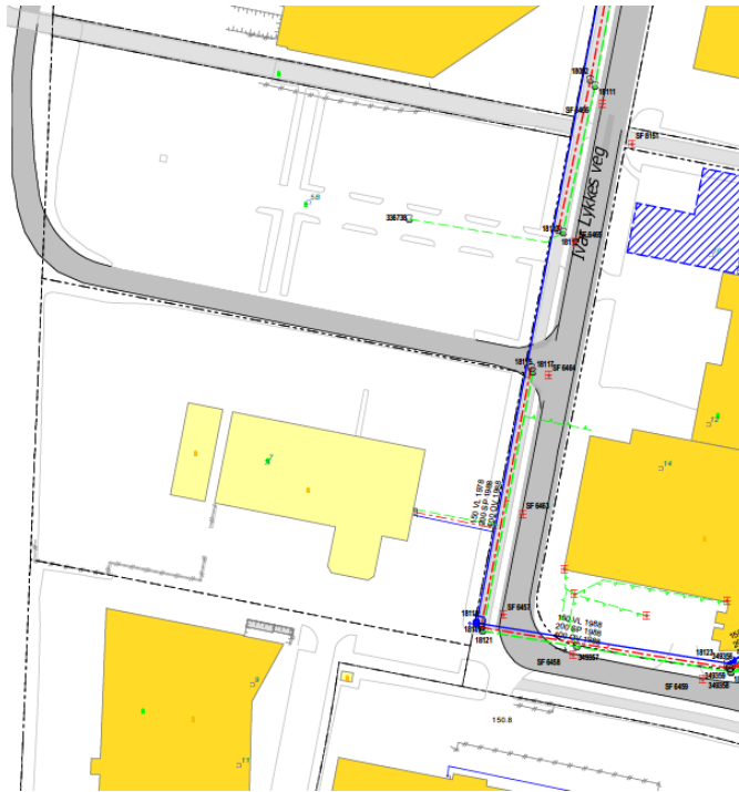
Figur 4: VA-ledninger i Ivar Lykes veg ved planområdet
